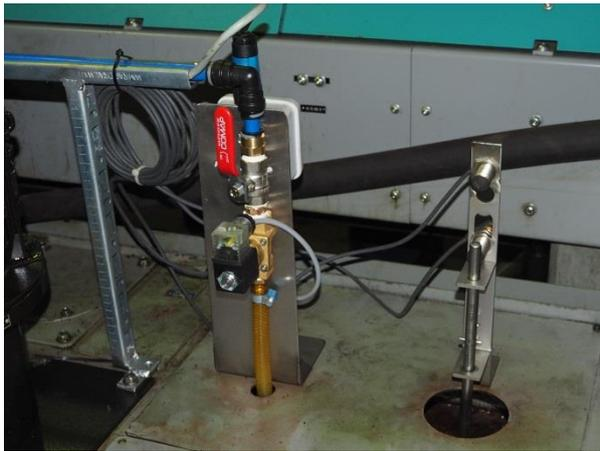
Abbildung 4: Der Schwimmerschalter rechts überwacht den Pegelstand des KSS im Tank. Das Ventil öffnet bei Bedarf und füllt immer Kleinmengen nach
